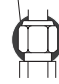
Ізоляційний матеріал та силіконовий герметик. Переконайтеся у відсутності щілин, де волога може потрапляти в з'єднання.
