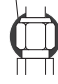
Изоляционен материал и силиконов уплътнител. Моля, внимавайте да няма отвори, през които да прониква влага в съединението.
