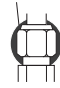
Material de isolamento e vedante de silício. Certifique-se de que não há folgas onde a humidade pode entrar na união.
